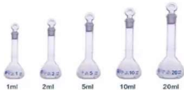
Мал. 4.2. У кожного пікнометра наявна риска. Наливаючи рідину до цієї риски (за нижнім краєм меніска), вимірюють певний об'єм рідини з дуже великою точністю
